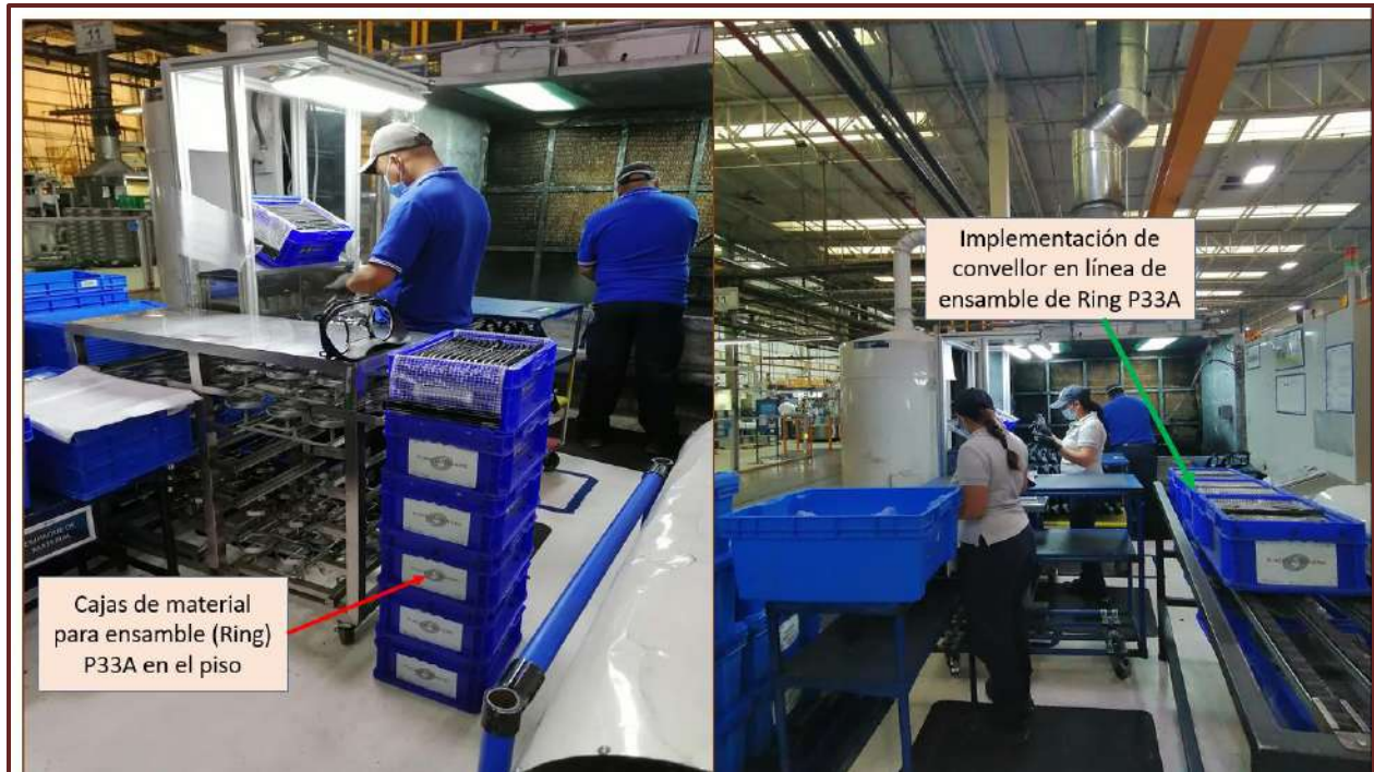
Ilustración17. Kaizen de instalación de convellor.
